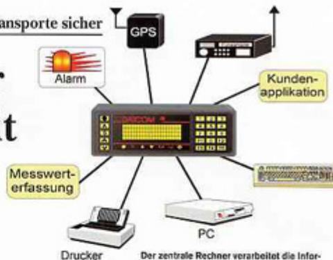
Der zentrale Rechner verarbeitet die Informationen der angeschlossenen Geräte und Module. Ausbeuten nach Kundenwunsch sind einfach möglich.
